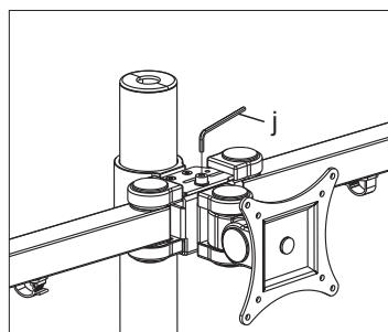
Okrećući vijak suprotno od smjera kazaljke na satu spuštate središnji monitor , a okrećući vijak u smjeru kazaljke na satu podižete monitor u sredini.
