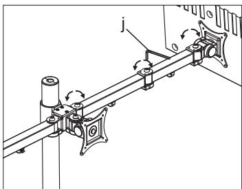
Uklonite plastični pokrov, pomoću imbusa (j) napravite dodatna podešavanja.
